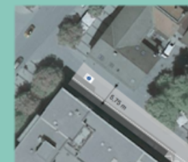
Sicherheitstrennstreifen mit verbleibender Fahrbahnbreite
